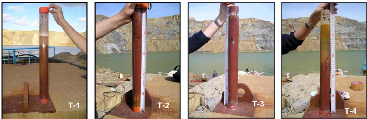
Figura 15.5. Testigos muestreados por el IGME en la corta de Aznalcóllar en marzo de 2005. Se pueden observar de visu claras diferencias en los sedimentos. Los sedimentos se presentaban muy embebidos en agua. Las cenizas púrpuras son los sedimentos dominantes.
